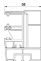
Guida (PVC) singola + MKT* - RS revisione dall'esterno. MK8120 + MK9760
